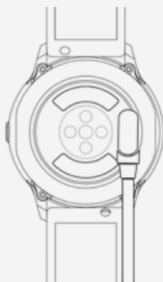
\* O carregamento da bateria do relógio deve-se efetuar conforme a imagem. O carregamento incorreto pode danificar o relógio. Atenção: os dois contatos do cabo USB não podem entrar em contato com o condutor em simultâneo, sob pena do circuito queimar.
