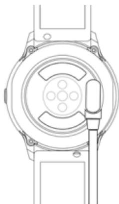
\*Cargue el reloj solo de la manera que se muestra. Una carga incorrecta puede dañar el reloj. Tenga en cuenta que no se permite que los dos contactos del cable USB entren en contacto con el conductor al mismo tiempo, o el circuito se quemará.
